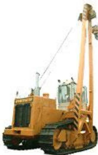
Рис. 12 Кран - трубоукладчик ТГ-221
