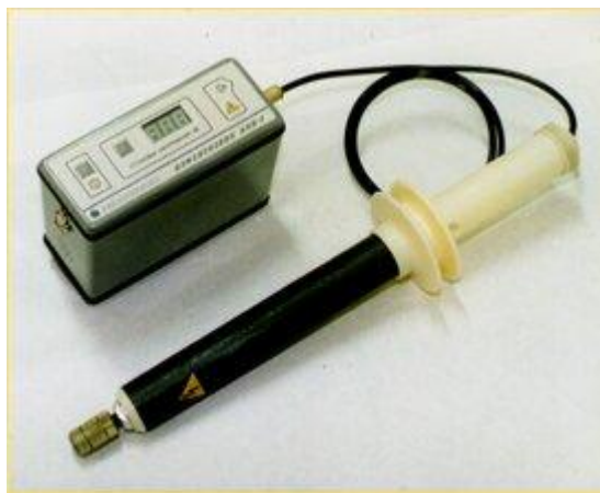
Рис.32 Прибор для контроля качества изоляционного покрытия
