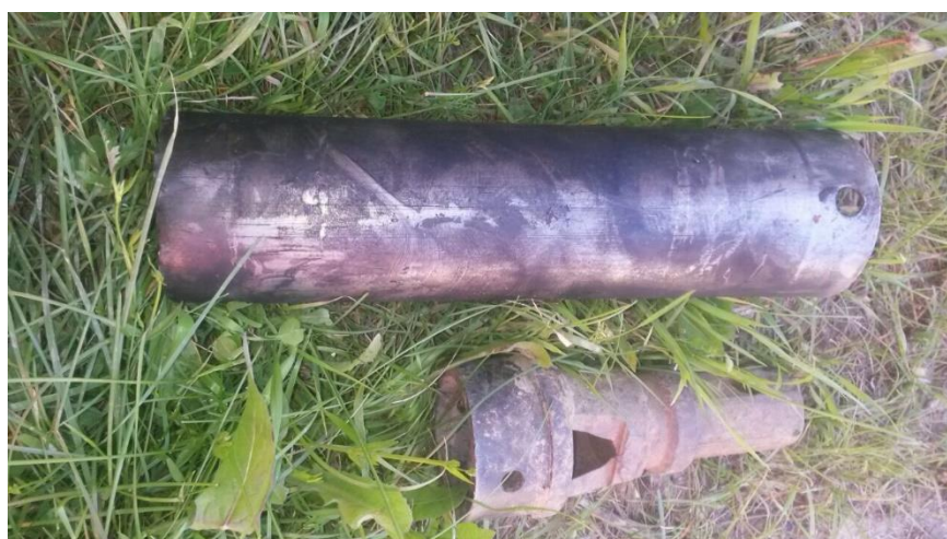
Рисунок 15 – Грунтонос, вдавливаемый ГВ-1
