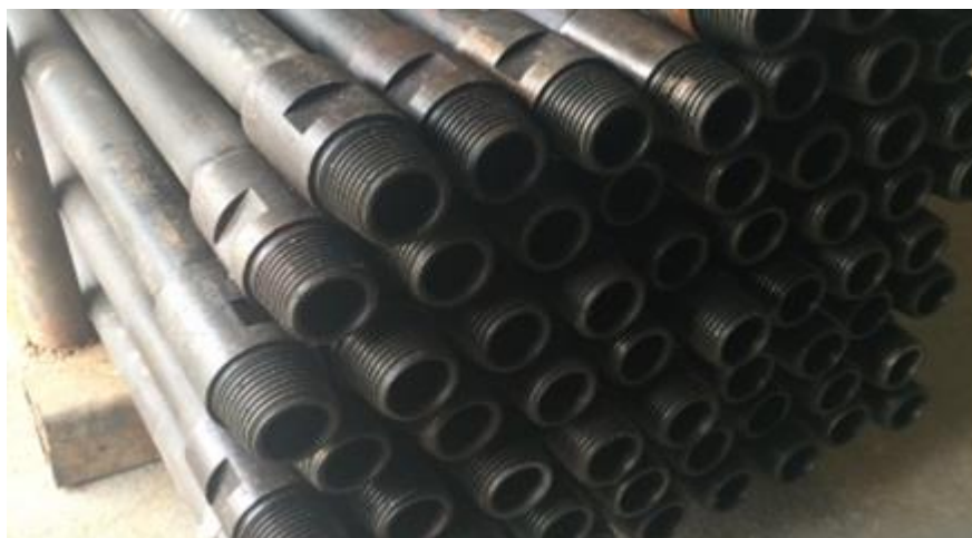
Рисунок 13 – Бурильные трубы ТБСУ II 50x4.5 [18]
