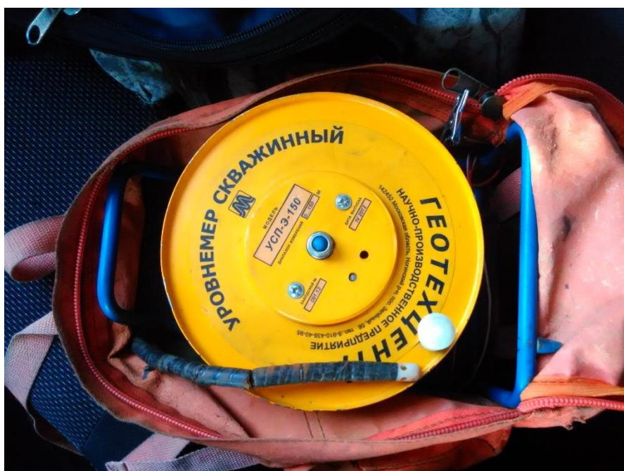
Рисунок 3.3.1 – Электронный уровнемер УСП-Э-150
