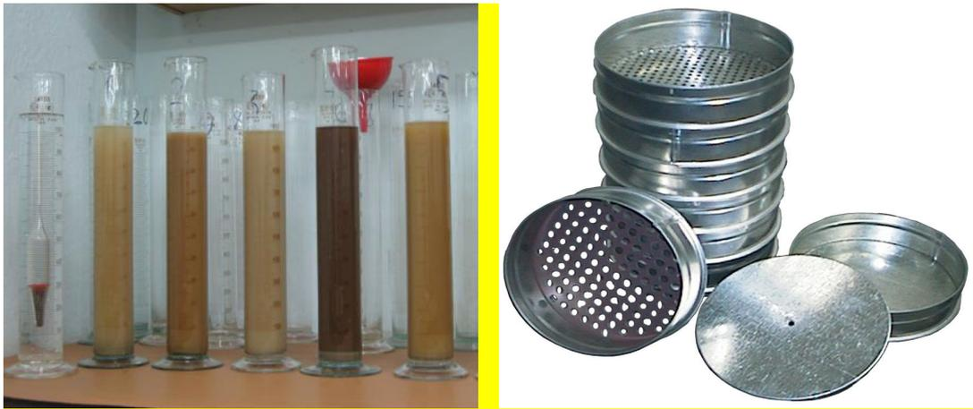
Рис. 3.7 Определение гранулометрического состава [67]
