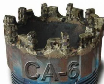
Рис.3.2 Твердосплавные коронки типа СМ5, СА6
