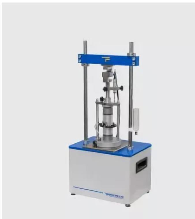
Рис. 3.8 Прибор для определения одноосного сжатия
