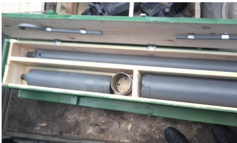
Рис.3.4 Грунтонос вдавливаемый [67]
