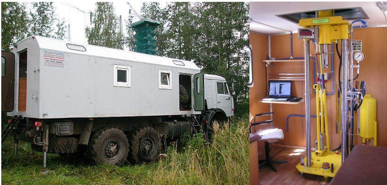
Рисунок 23 – Установка статического зондирования УСЗ 15/36А на базе КАМАЗ 43114
