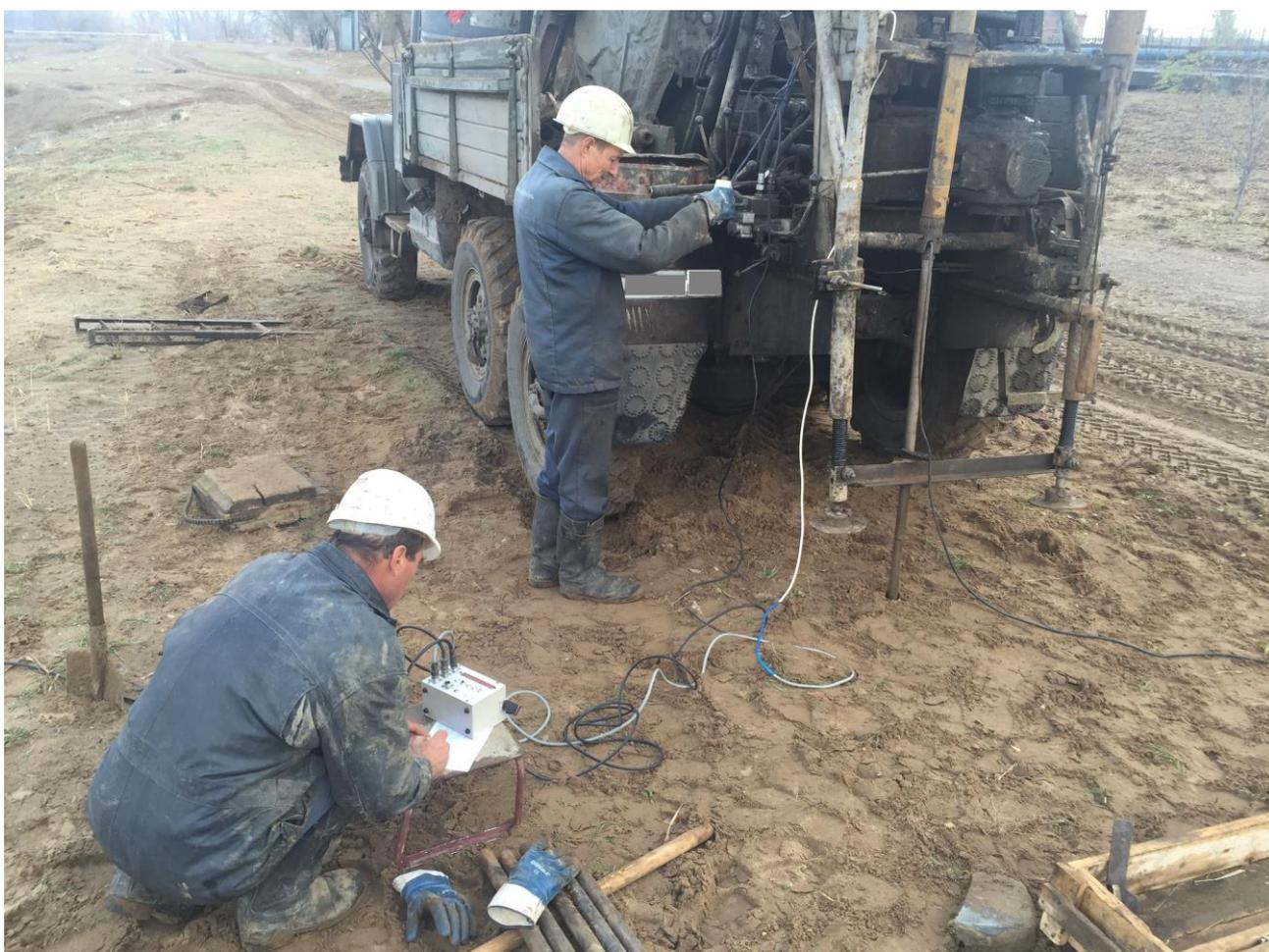
Рисунок 19 – Статическое зондирование грунтов
