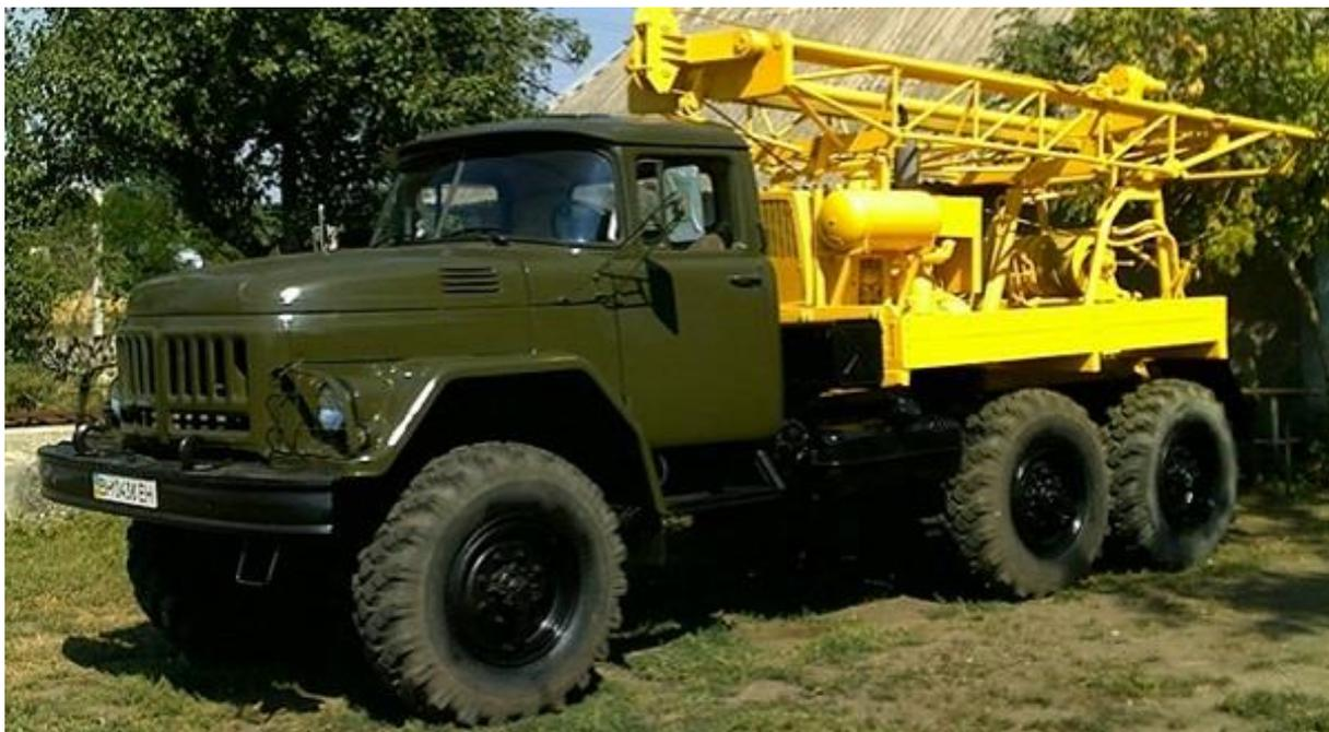
Рисунок 17 – Буровая установка УГБ-1ВС
