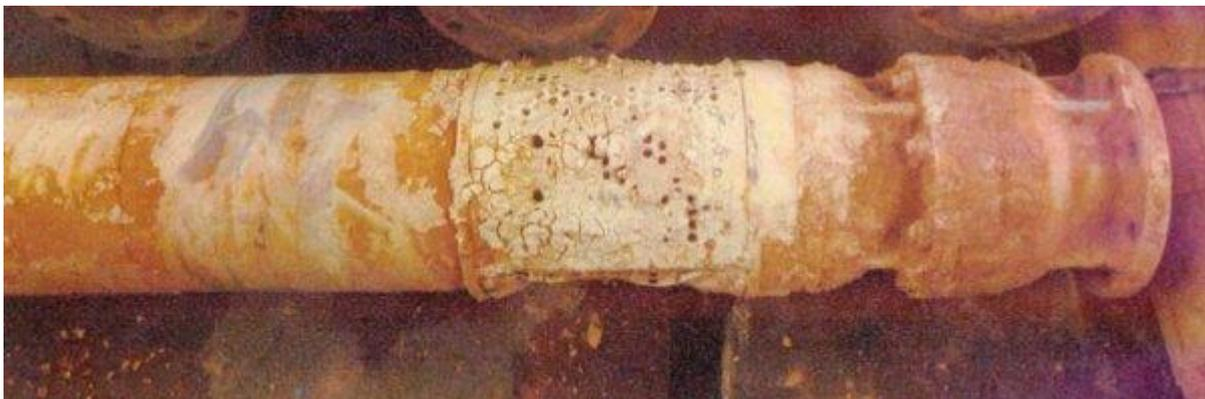
Рисунок 9 – отложение оксидов железа
