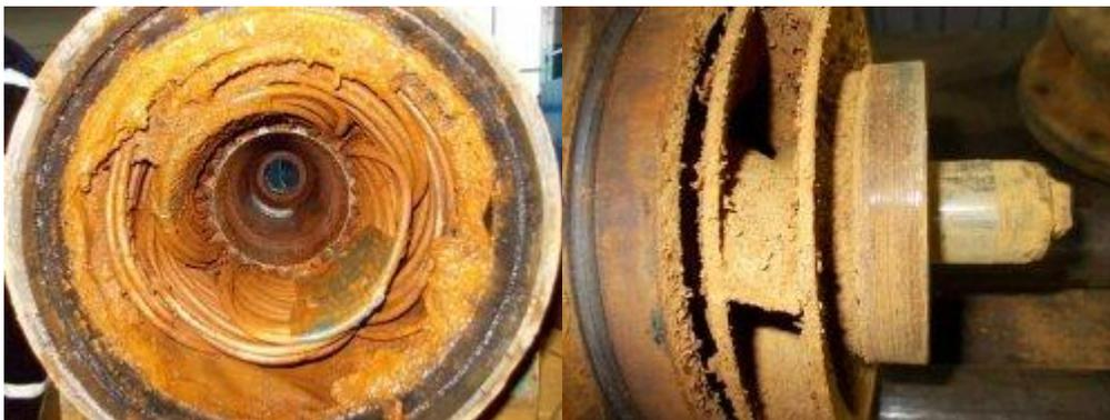
Рисунки 10 – Отложения оксидов железа на насосе
