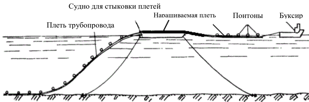
Рисунок 5 – Схема укладки свободным погружением с буксировкой
