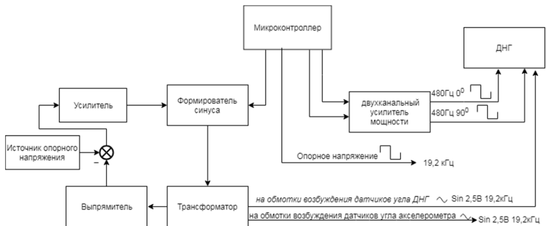
Рис. 2. Модернизированная структурная схема задающего генератора
