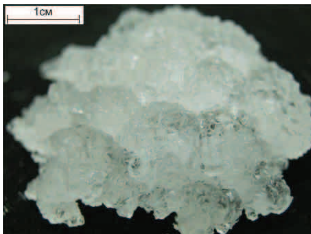
Рис. 2. Оплав и спек десублимата гексафторосиликата аммония
