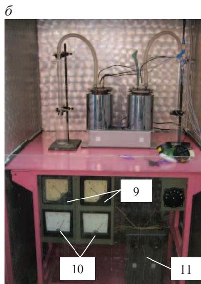
**Рис. 2.** Принципиальная схема лабораторной установки теплотехнологической переработки низкосортного сырья (а) и ее вид в сборе (б): 1 - нагревательный элемент, 2 - реактор, 3 - система термодатчиков, 4 - регистратор температуры, 5 - термостойкий шланг, 6 - емкость-холодильник, 7 - дополнительный холодильник, 8 - опора, 9 - амперметр, 10 - вольтметр, 11 - автотрансформатор
