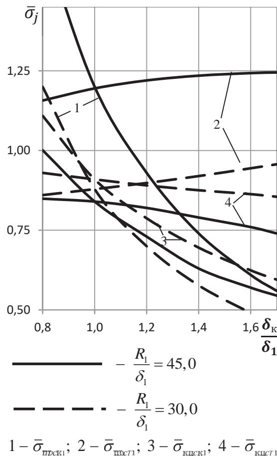
**Рис. 1.** Графические зависимости параметров напряжений от отношения толщин стенок конического переходника и трубопровода
