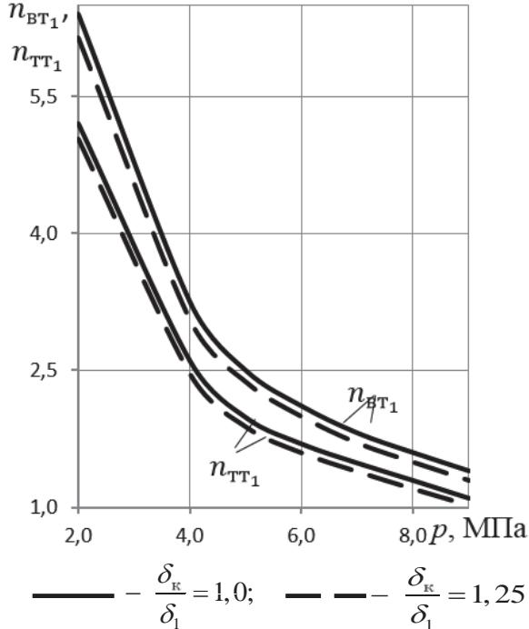
**Рис. 3.** Графические зависимости запасов прочности конического перехода трубопровода от внутреннего давления
