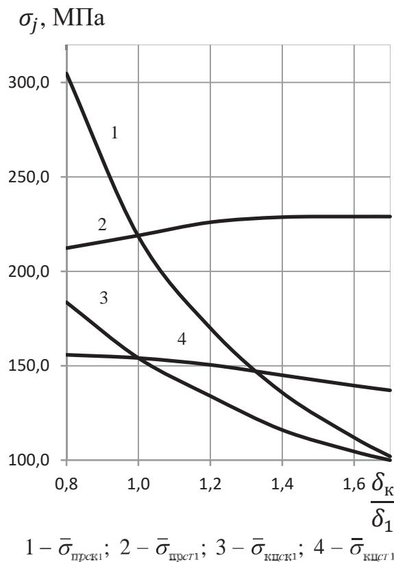
**Рис. 2.** Графические зависимости напряжений  $\sigma_{\text{прск1}}, \sigma_{\text{прст1}}, \sigma_{\text{кцск1}}$  и  $\sigma_{\text{кцст1}}$  от  $\frac{\delta_k}{\delta_1}$  при рабочем давлении  $p=4,0 \text{ МПа}$
