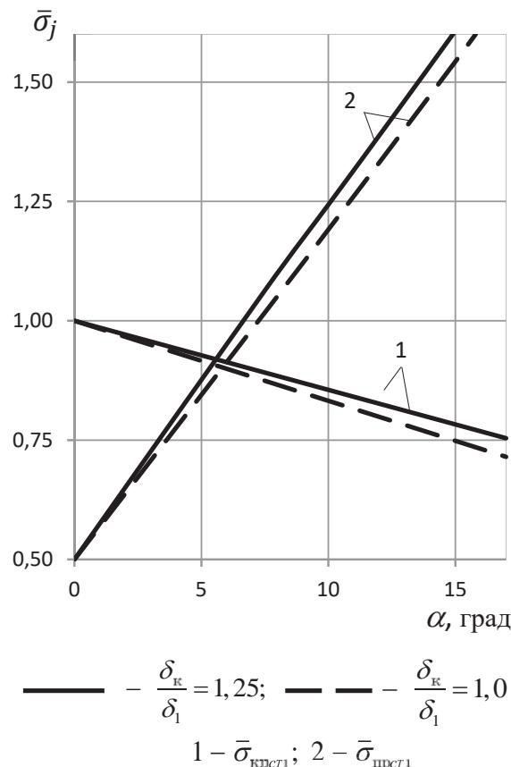
Рис. 4. Графические зависимости  $\bar{\sigma}_{kst1}$ ,  $\bar{\sigma}_{pst1}$  от угла наклона образующей переходника
