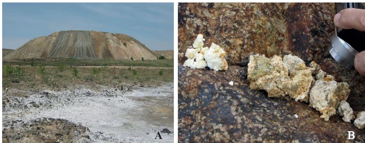
Рис. 2. Выцветы солей по периферии временного водоема на хвостохранилище (А) и конгломераты новообразованных гипергенных минералов в затененных частях карьера (В)
