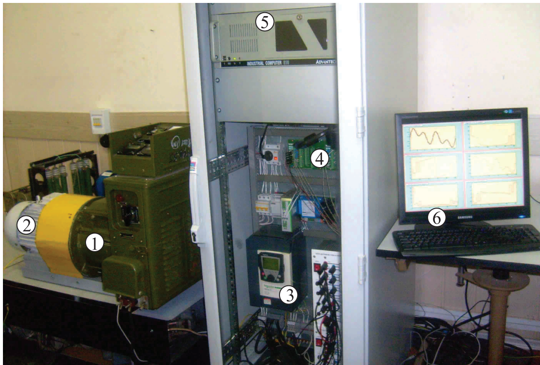
Рис. 1. Экспериментальная установка: 1 – синхронный генератор; 2 – асинхронный двигатель; 3 – преобразователь частоты; 4 – коннектор ввода; 5 – промышленный компьютер; 6 – монитор
