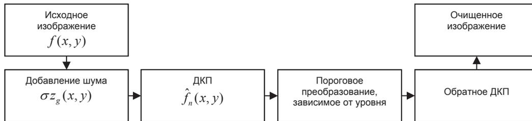
Рис. 3. Схема метода предобработки при помощи кривлет-преобразования
