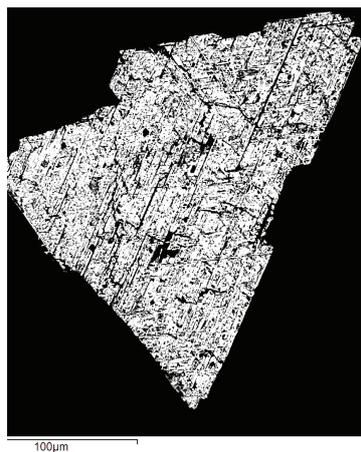
**Рис. 6.** Мартитизированный кристалл титаномагнетита с текстурой избирательного выщелачивания. Калишпатизированный плаггиогранит-порфир, главная фаза, Алейский массив
