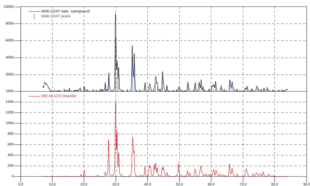
Рис. 3. Дифрактограмма петроситалла класса СКС, на основе базальта (№ 1) Полярного Урала (вверху) в сравнении с эталонным диопсидом № 000–41–1370 (внизу)
