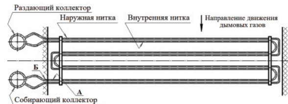
Рис. 1. Вид сверху на горизонтальный пароперегреватель парового котла
