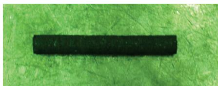
Рис. 2. Внешний вид электрода из облученного графита
