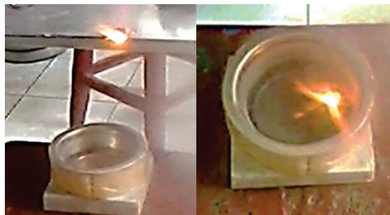
**Рис. 2.** Фотографии процесса зажигания и горения таблеток из смеси нанопорошка алюминия с пентаоксидом тантала: инициирование горения в воздухе и горение в жидком азоте
