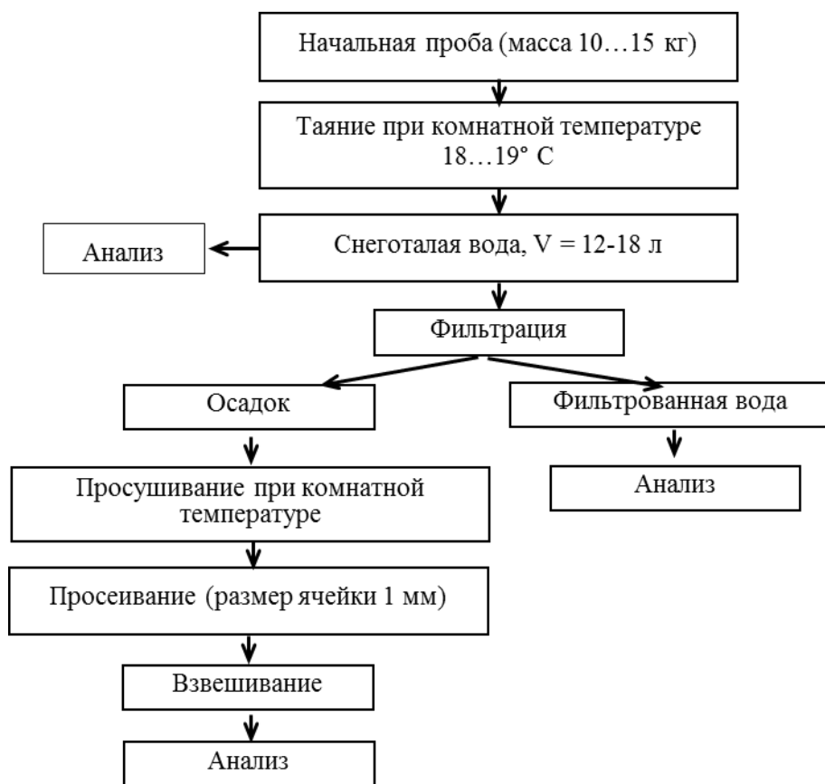
Рисунок 3.1 - Схема обработки и изучения снеговых проб
