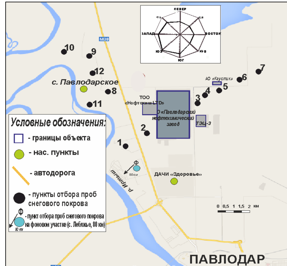
Рисунок 3.2 - Схема отбора проб снежного покрова в окрестностях: а) Омского НПЗ (2016 г.); б) Томскнефтехима (2016 г.); в) Ачинского НПЗ (2016 г.); г) Павлодарского НХЗ» (2015 г.).
