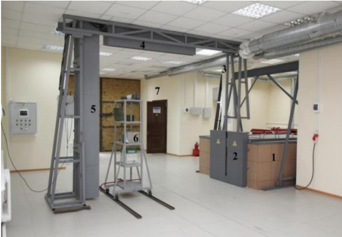
Рисунок 4.1 - Инспекционно-досмотровый комплекс с бетатроном МИБ-9 [138]:
