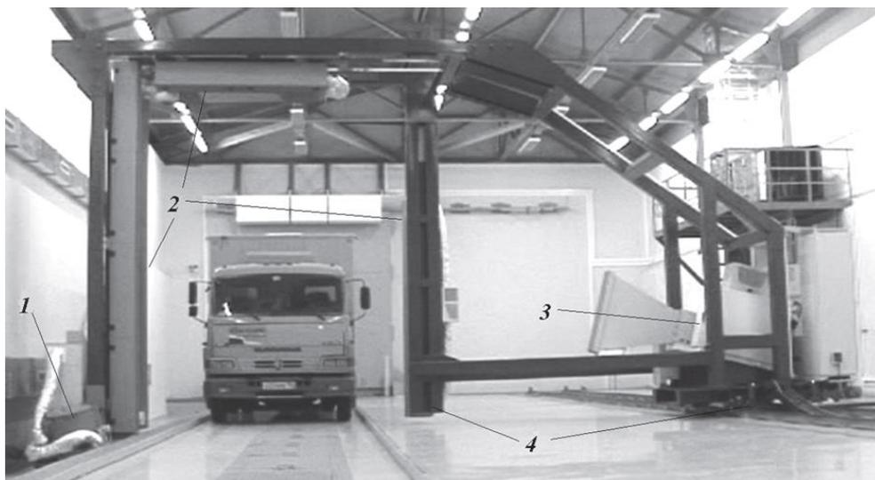
Рисунок 2.1 - Расположение основного технологического оборудования досмотрового радиометрического комплекса (ДРК) [88]:
