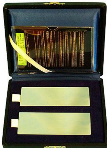
Рисунок 1.15 - Комплект никель-хромовых тест-панелей с эталонной фотографией полученных дефектов
