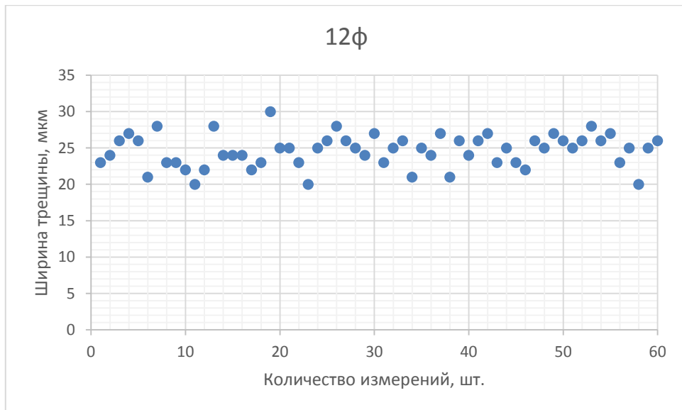
Рисунок 4.19 - Распределение ширины дефекта по длине на образце №12ф
