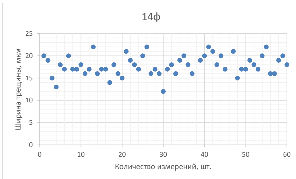
Рисунок 4.21 - Распределение ширины дефекта по длине на образце №14ф
