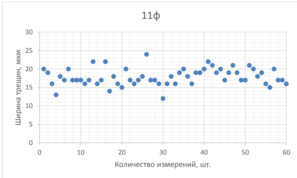
Рисунок 4.18 - Распределение ширины дефекта по длине на образце №11ф
