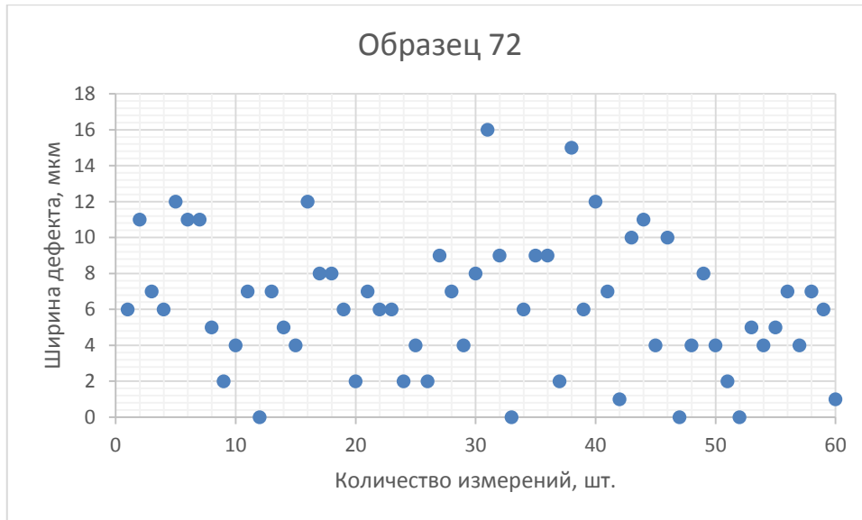
Рисунок 4.14 - Распределение ширины дефекта по длине на образце №72
