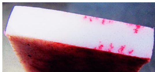
Рисунок 1.2 - Дефекты на поверхности изделия из фторопласта, обнаруженные капиллярным контролем
