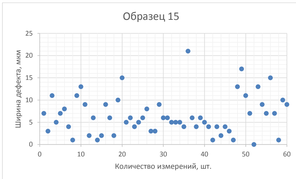
Рисунок 4.15 - Распределение ширины дефекта по длине на образце №15
