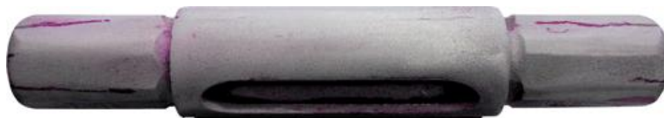
Рисунок - 1.8. Объект контроля с естественными дефектами
