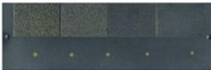
Рисунок 1.17 – Тест-панель 2 типа по ISO 3452 - 3
