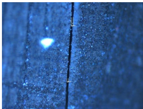
Рисунок 4.12 – Дефект в образце, полученный вытравливанием
