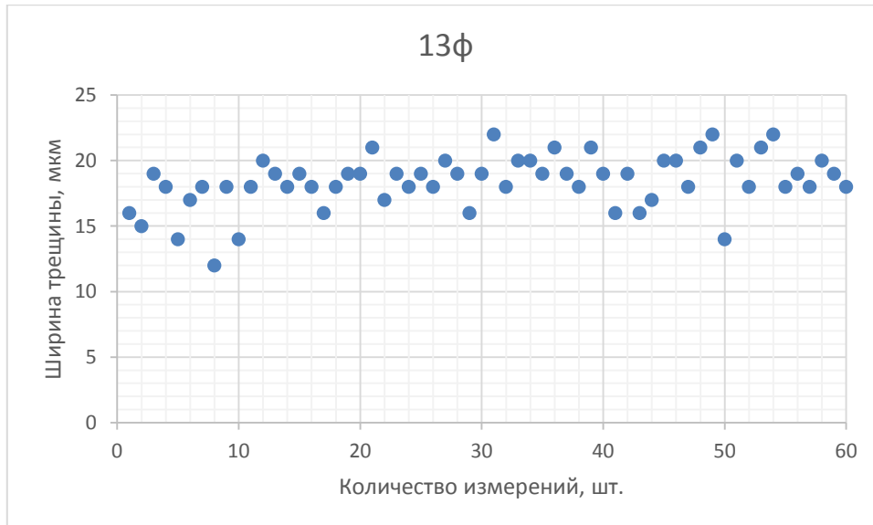
Рисунок 4.20- Распределение ширины по длине на образце №13ф
