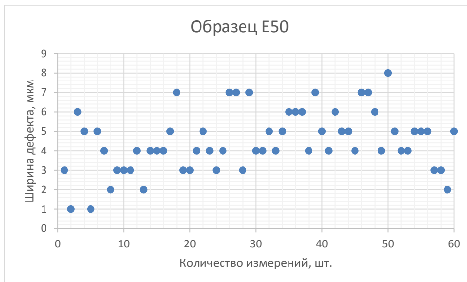
Рисунок 4.17 - Распределение ширины дефекта по длине на образце E50
