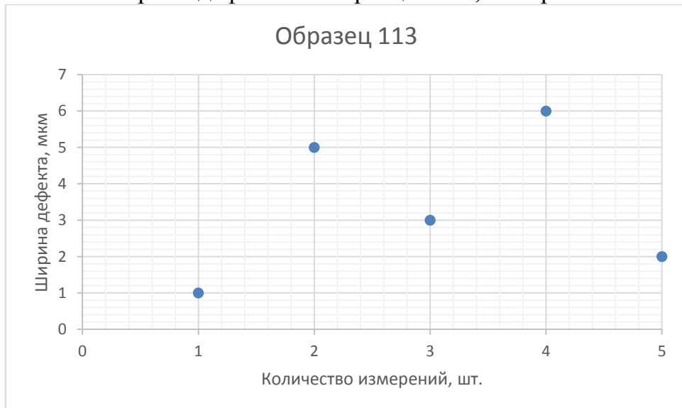
Рисунок 4.4 - Ширина дефекта на образце №113, измеренная в 5 точках
