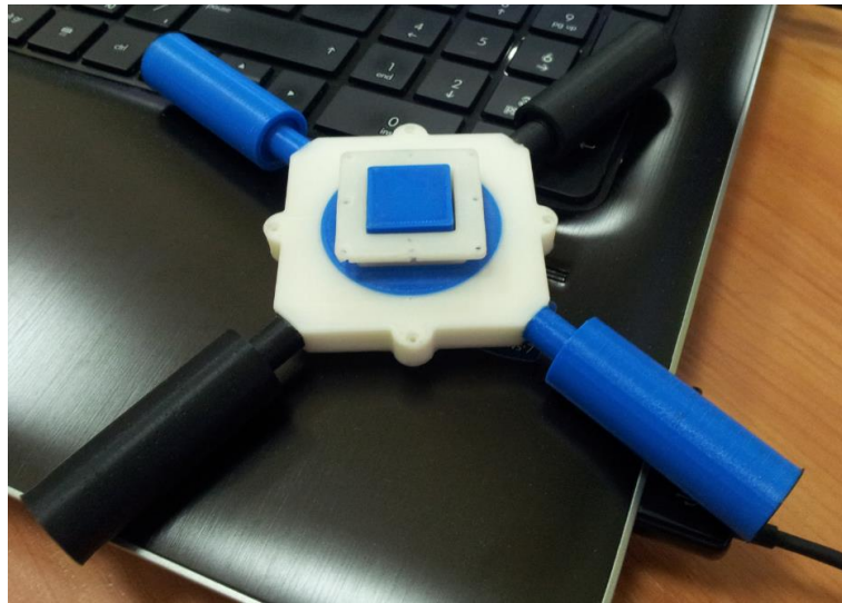
Рисунок 3.23 – Модель и 3D прототип прессовой оснастки для прессования изделия в форме рамки заданных размеров под действием УЗ-колебаний.
