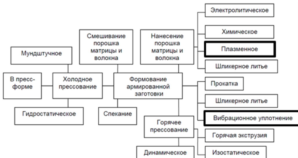
Рисунок 1.1 - Схема технологического процесса производства ММК методами порошковой металлургии
