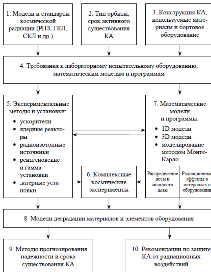
Рисунок 1.7 - Схема организации исследований воздействия космической радиации [90]
