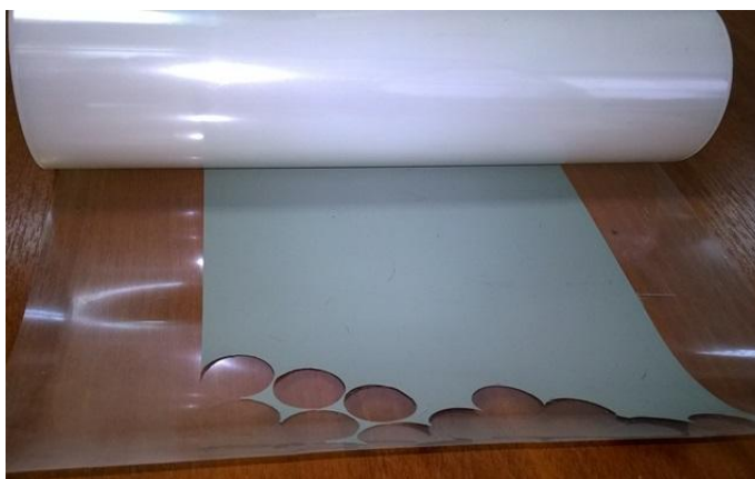
Рисунок 2.18 – Анодная шликерная лента фирмы ESL ElectroScience, США (anode tape 42421).
