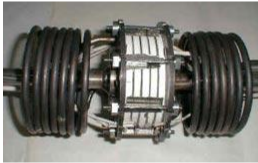
Рисунок 1.10 – Экспериментальная батарея планарных ТОТЭ, разработанная в ФГУП «ГНЦ РФ – ФЭИ» [97].
