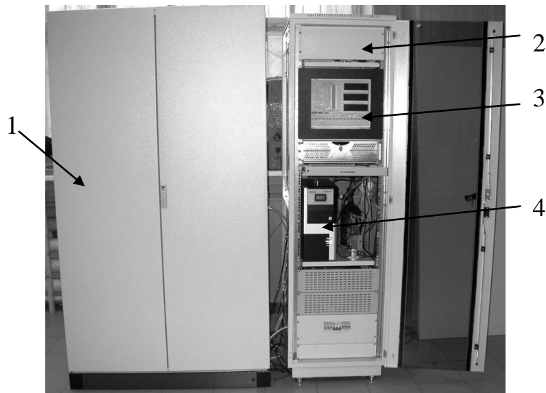
Рисунок 2.13 – Внешний вид стенда для исследования характеристик твердооксидных топливных элементов диаметром 50 мм: 1 – шкаф с нагревателем и блоком его питания, 2 – блок управления, 3 – промышленный компьютер, 4 – генератор водорода.
