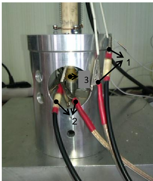
Рисунок 2.12 – Блок коммутации газов: 1 – анодные токосъемные провода для подключения приборов; 2 – катодные токосъемные провода для подключения приборов; 3 – трубка для подачи водорода.
