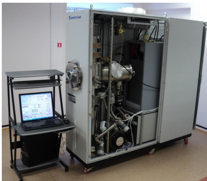
Рисунок 2.1 – Внешний вид экспериментальной автоматизированной установки для изготовления многослойных структур твердооксидных топливных элементов.
