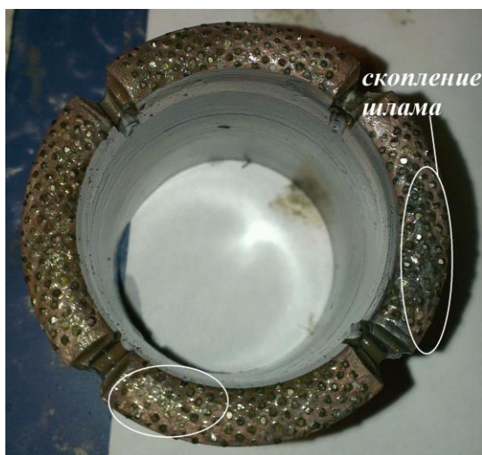
Рисунок 3.8 – Пример скопления шлама на сбегаящей части сектора коронки
