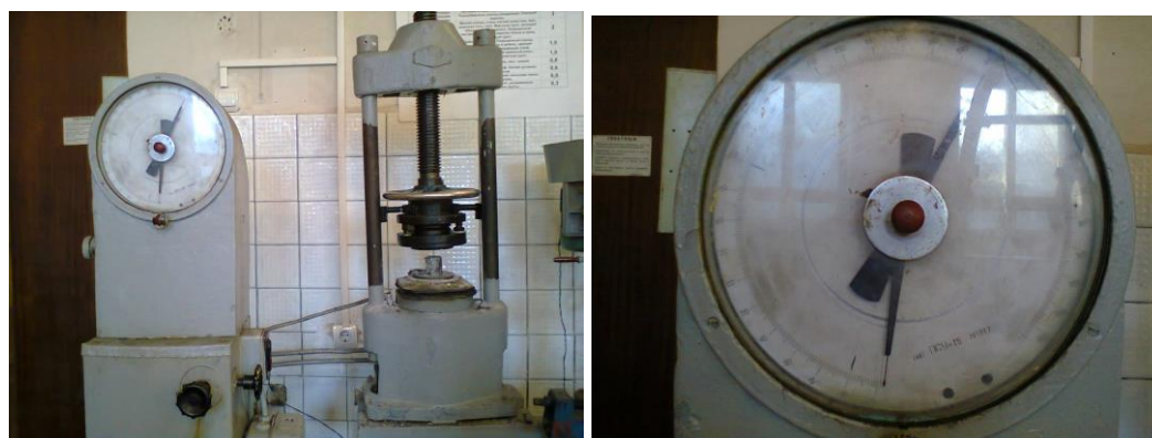
Рисунок 3.4 – Установка ПСУ-15: а – общий вид; б – датчик прибора (показание 200 кН)
