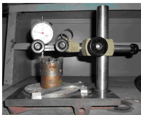
Рисунок 3.2 – Измерительная стойка с индикаторной головкой типа МИГ-1
