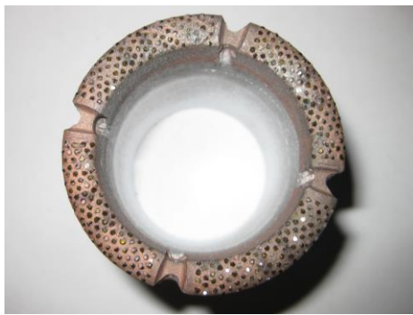
Рисунок 2.50 – Торец, серийно изготавливаемой однослойной алмазной коронки
