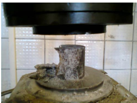
Рисунок 3.5 – Характер разрушения образца породы при одноосном сжатии
