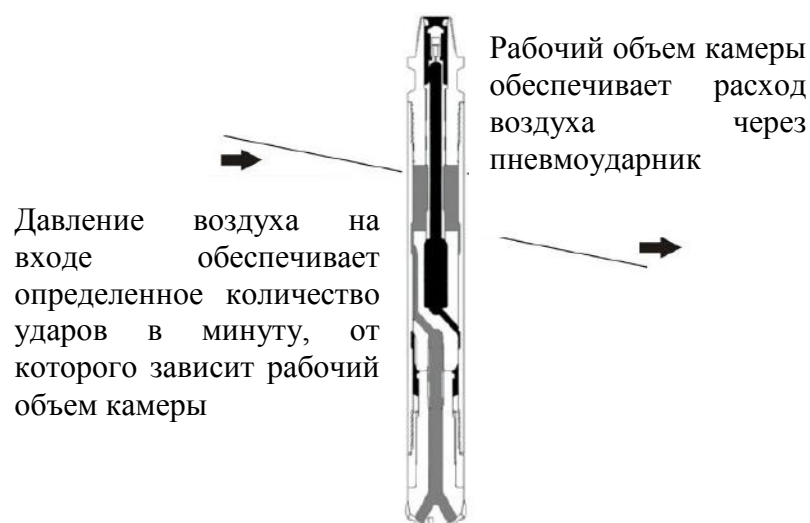
Рисунок 8 – Превращение энергии потока воздуха в энергию ударов ППУ
