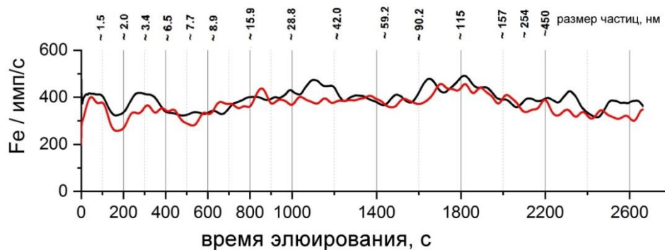
Рисунок 36 – Распределения Fe в воде штольни №177 в зависимости от размера частиц
