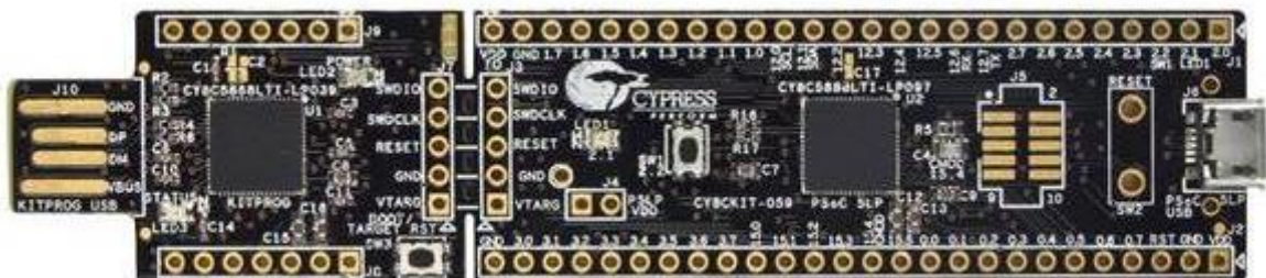
Рисунок 54 – Внешний вид платы PSoC CY8CKIT-059
