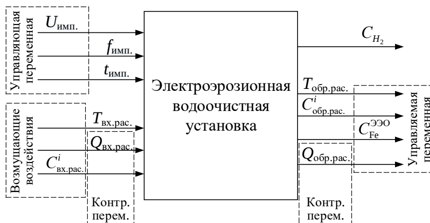
Рисунок 4 – Информационная структура электроэрозионной водоочистной установки как объекта управления
