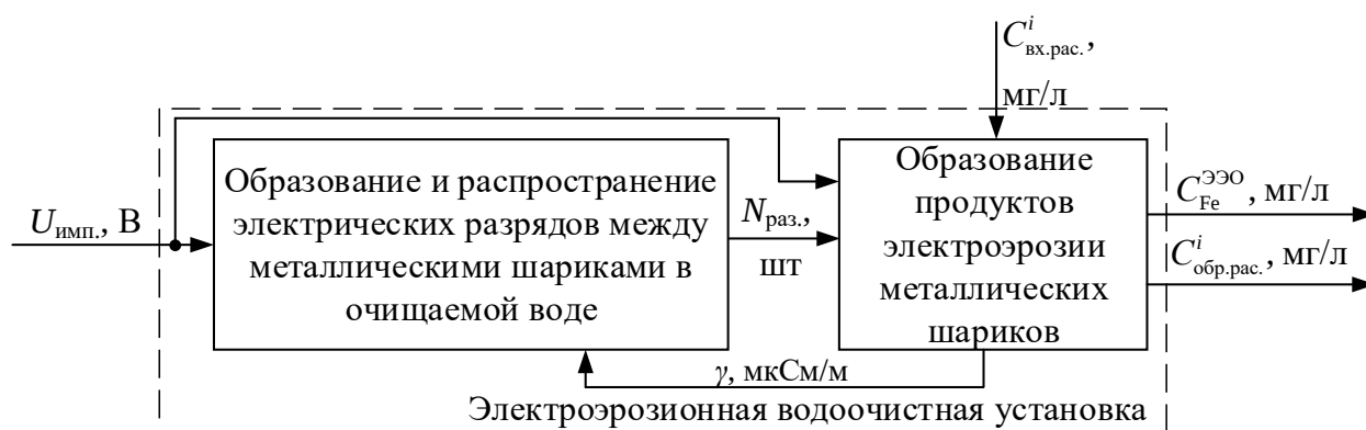
Рисунок 5 – Информационная модель электроэрозионной водоочистной установки как объекта моделирования
