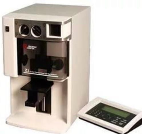
Рисунок 1.4 – Внешний вид кондуктометрического анализатора частиц Beckman Coulter Z1
