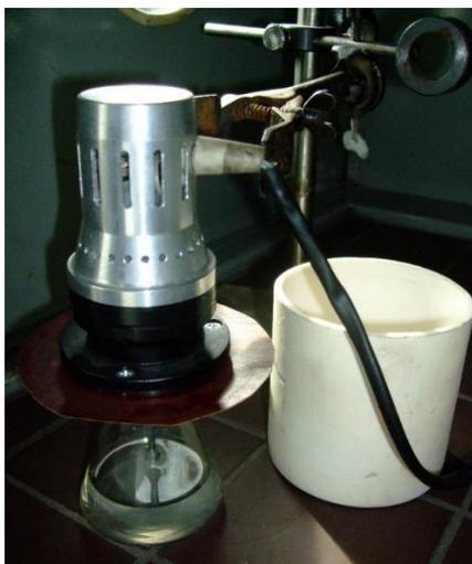
Рисунок 4.8 – Рабочий элемент ультразвукового миксера «Алёна» с реактором
