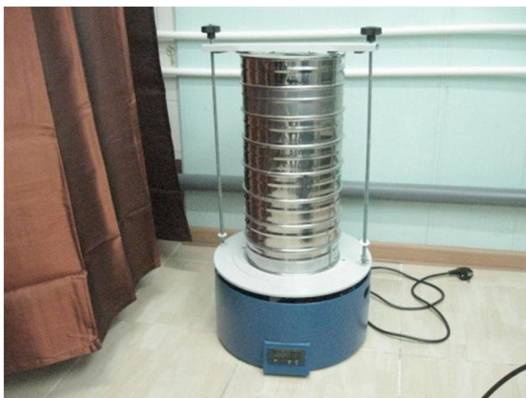
Рисунок 1.2 – Внешний вид ситового анализатора частиц
