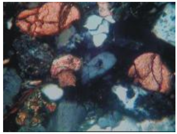
(б) Соболиная 181, гл. 2136,95; пласт Б 12 1 2 ник. Кп = 22,9 %; Кпр = 493,2 мД. Акцессорные минералы: эпидот и сфен
