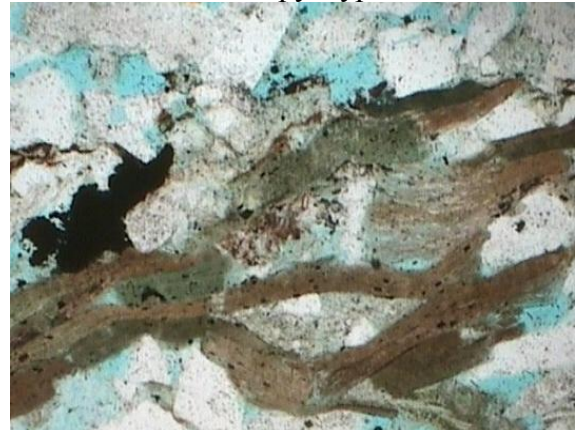
(е) Соболиная 181, гл. 2252,48; пласт Б 11 2 ; 2 ник. Кп = 20,7 %; Кпр = 16,1 мД. Гидратизированные пластинки биотита, заполняющие поровое пространство
