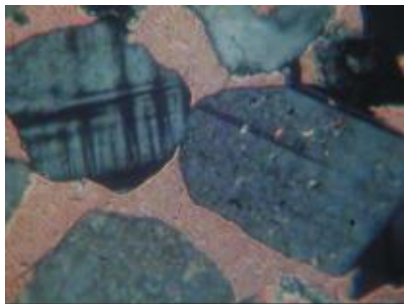
(б) Соболиная 181, гл. 2136,8; пласт Б 12 1 ; 2 ник. Кп = 24,6 %; Кпр = 983,0 мД. Хорошо окатанные зерна полевых шпатов. Поровый кальцитовый цемент.
