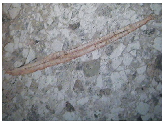
(б) Соболиная 213, гл. 2249,13; пласт B_{11}^1 ; 1 ник. Кп = 21,5 %; Кпр = 7,3 мД. Фосфатизированный остаток фауны
