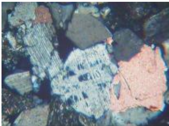
(д) Гуларинская 13, гл. 2246.2, 2 ник; Кп=21,1 %; Кпр=27,2 мД. Поры выщелачивания в полевом шпате. Замещение полевого шпата кальцитом.
