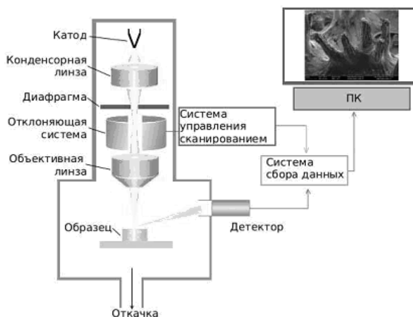
Рисунок 2.16 – Принципиальная схема СЭМ
