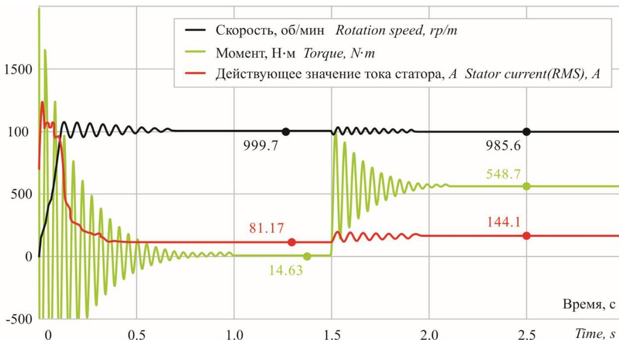
Рисунок 2.13. Динамические характеристики прямого пуска ТАД с заводскими параметрами на пониженное напряжение 178 В и схемой соединения обмоток статора «Δ»
