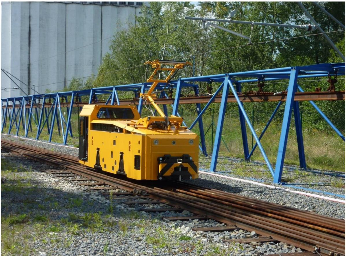
Рисунок 2.14. Контактный подземный локомотив TLP90F фирмы «*Ferrit*»
