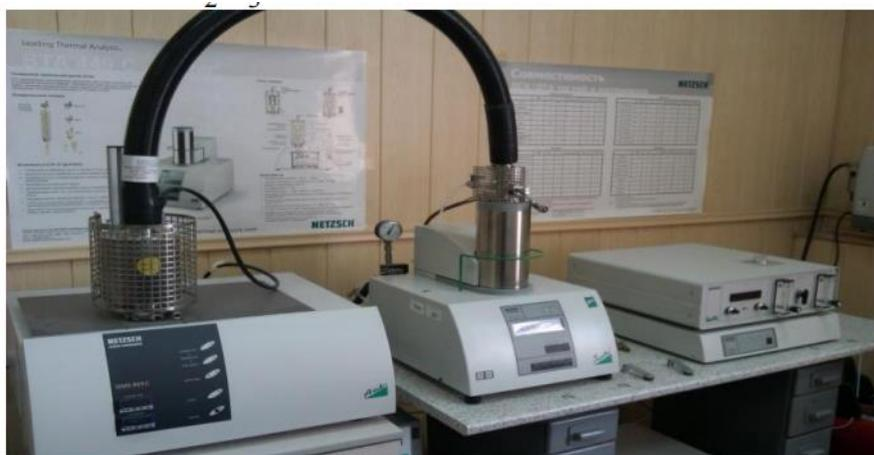
Рисунок 2.18 – Синхронный термический анализатор STA 449C Jupiter
