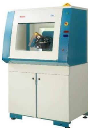
Рисунок 2.5 – Дифрактометр ARL X'TRA
