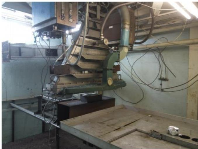
Рисунок 2.14 – Вид электронного ускорителя ИЛУ-6
