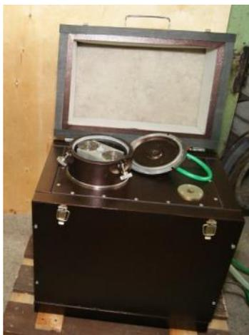
Рисунок 2.1 – Внешний вид шаровой мельницы планетарного типа АГО-2С
