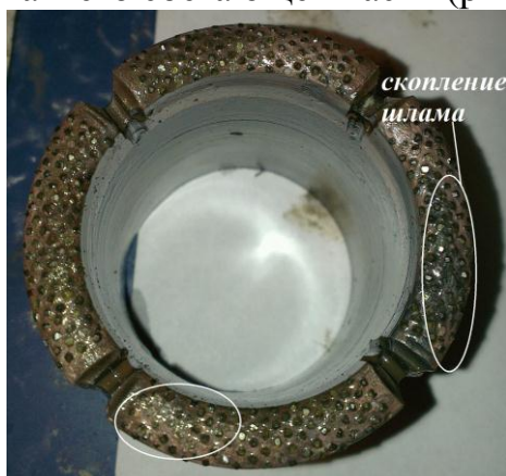
Рисунок 6 – Пример скопления шлама на сбегающей части сектора коронки
