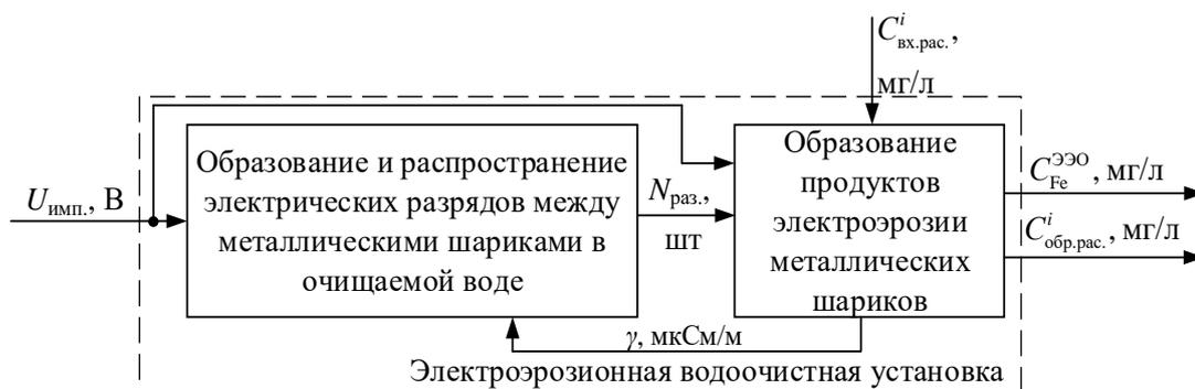
$N_{\text{раз.}}$  – количество разрядов, возникающих между металлическими шариками, загруженными в межэлектродное пространство установки;  $\gamma$  – электрическая проводимость водного раствора
