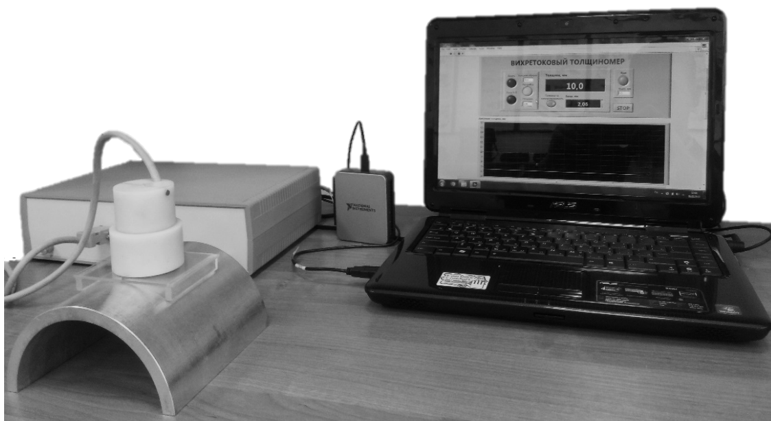
Рисунок 11 – Вихретоковый толщиномер. Внешний вид
