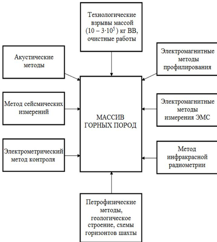
Рисунок 5 – Применяемые методы для исследования электромагнитной эмиссии горных пород при изменениях напряженно-деформированного состояния породного массива
