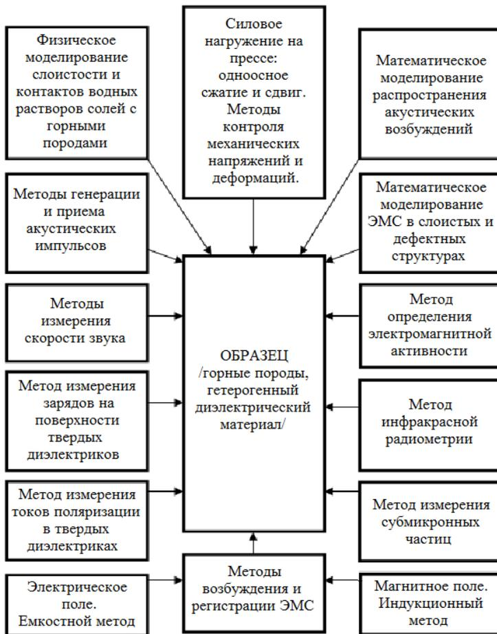
Рисунок 4 – Применяемые методы для исследования свойств и электромагнитной эмиссии образцов горных пород и гетерогенных диэлектрических материалов при акустическом возбуждении и силовом нагружении
