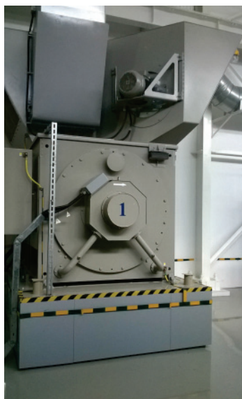
Рис. 2. Асинхронный двигатель Siemens 1TA2832-4AU01-Z в сборе с системой воздушного охлаждения
