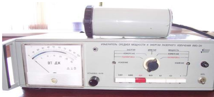
Рисунок 6.6 – Измеритель средней мощности и энергии лазерного излучения ИМО-2
