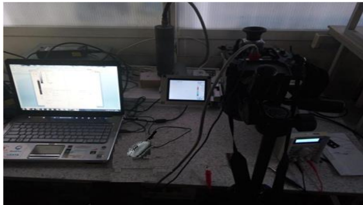
Рисунок 4.6 – Экспериментальный стенд для тепловизионных измерений
