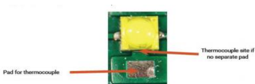
Рисунок 1.19 – Расположение термопары в СД [58]
