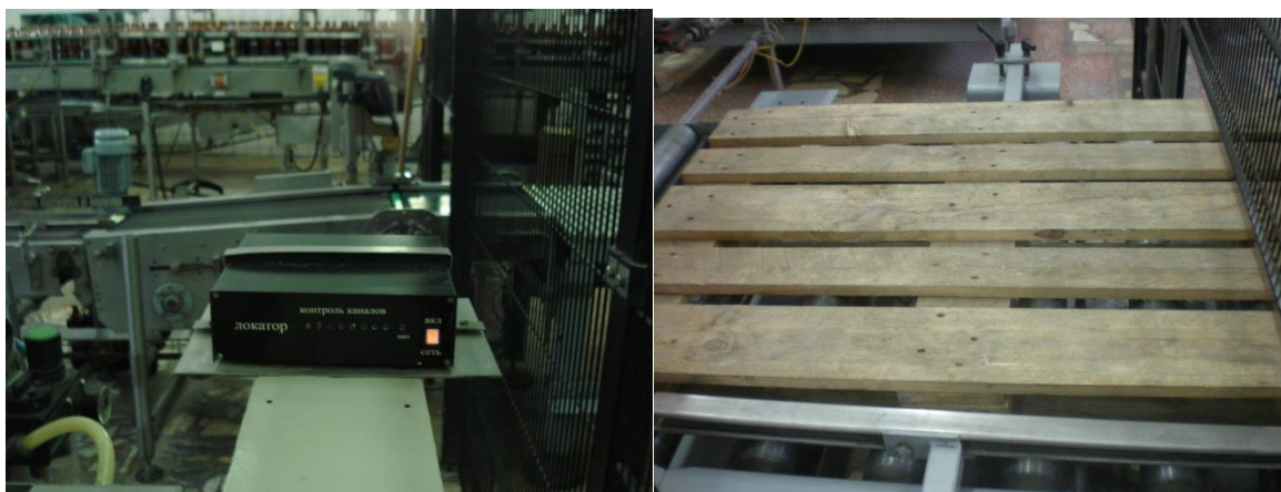
Рисунок 3.10 – Блок электроники системы автоматической сортировки паллет (а), механизм подачи паллет с установленной паллетой (б)
