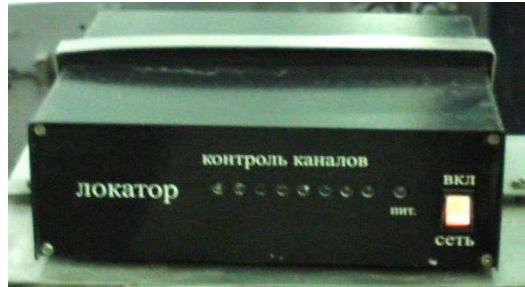
Рисунок 3.2 – Фотография электронного блока программно-аппаратного комплекса для контроля паллет
