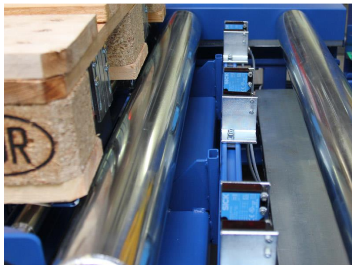
Рисунок 1.14 – Проверка нижних оснований поддона
