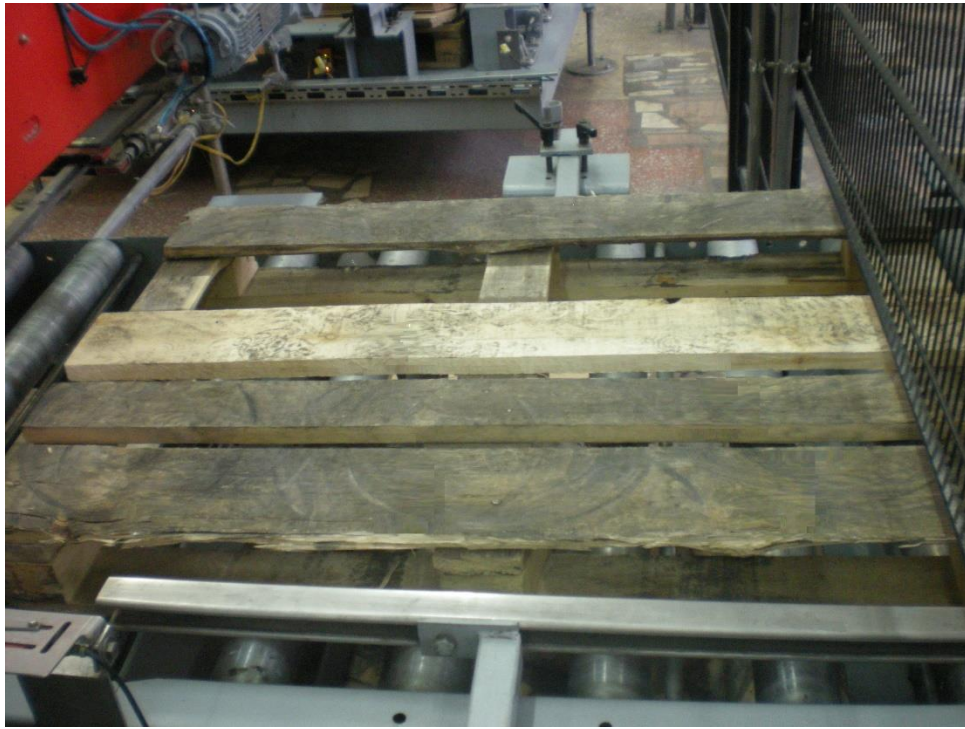
Рисунок 3.22 – Фотография поддона с нарушением целостности верхней поверхности
