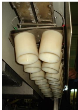
Рисунок 3.1 – Двухчастотная акустическая решетка
