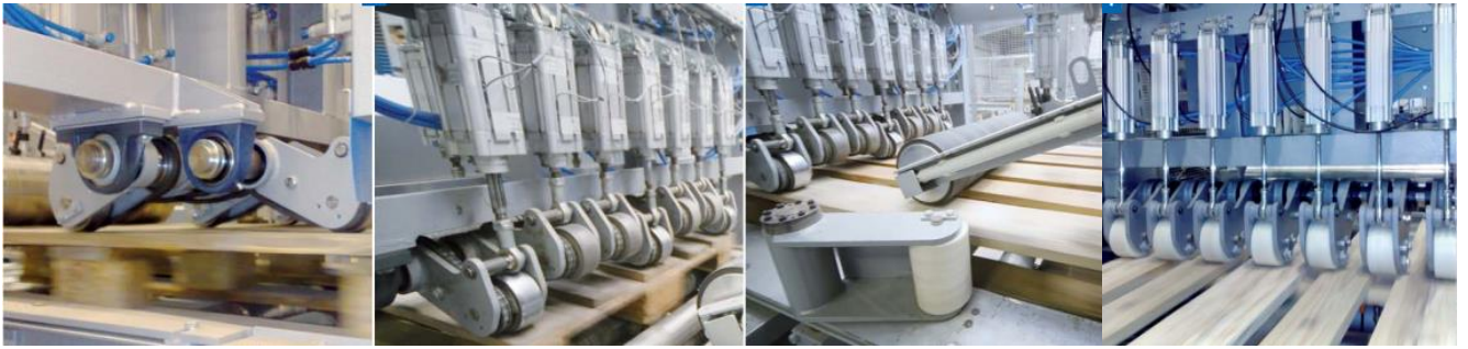
Рисунок 1.15 – Общий вид пневматических прижимных роликов
