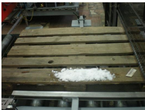
Рисунок 3.24 – Результаты экспериментальных исследований паллет с дефектом в виде снега, (а) – фотография, (б) – реконструкция поверхности паллеты
