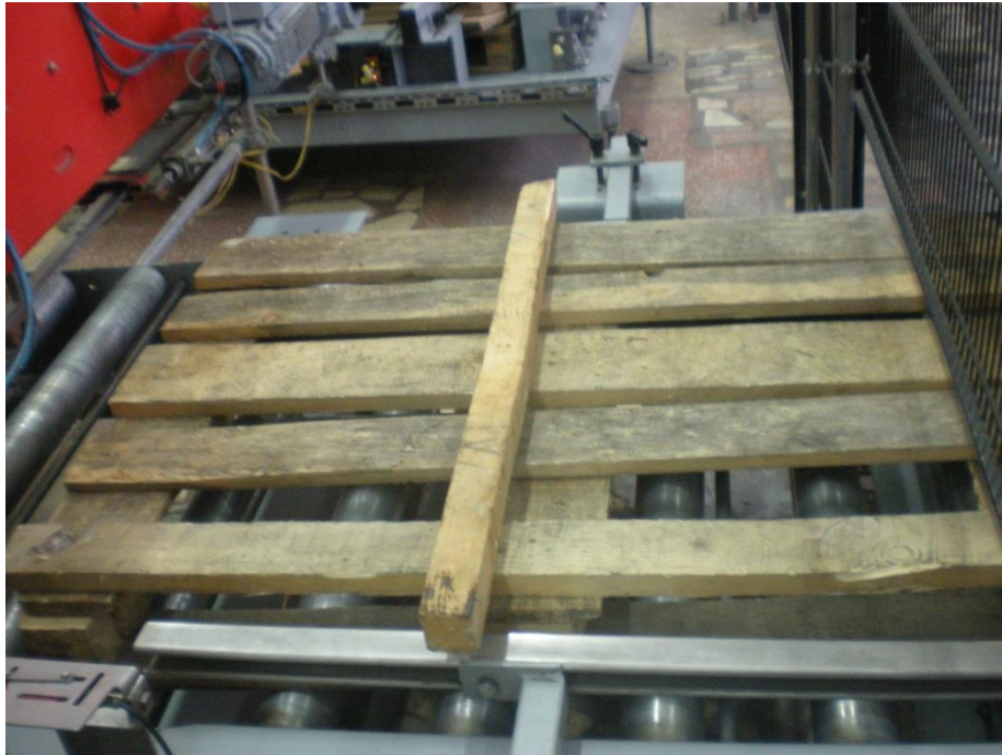
Рисунок 3.20 – Фотография поддона с посторонним предметом в виде бруска и выломанной верхней доской
