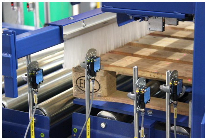
Рисунок 1.10 – Контроль габаритных размеров паллет
