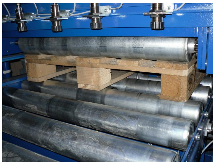
Рисунок 1.12 – Контроль выпирающих предметов на поверхности поддона
