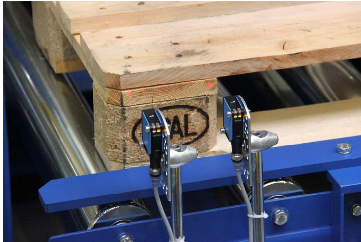
Рисунок 1.9 – Контроль поперечных скрепляющих досок с помощью фотодатчиков
