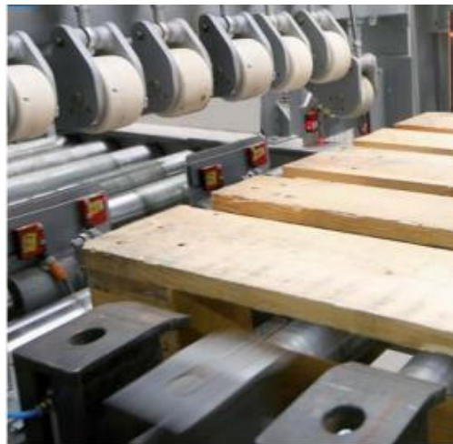
Рисунок 1.16 – Лазерные датчики для определения расстояния между досок
