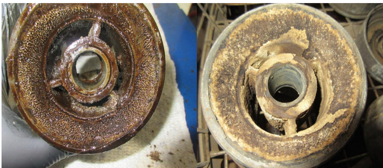
Рисунок 5 - Отложения солей на рабочем колесе электроцентробежного насоса
