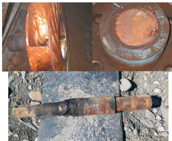
Рисунок 3.6 – Излом (разрушение) вала
