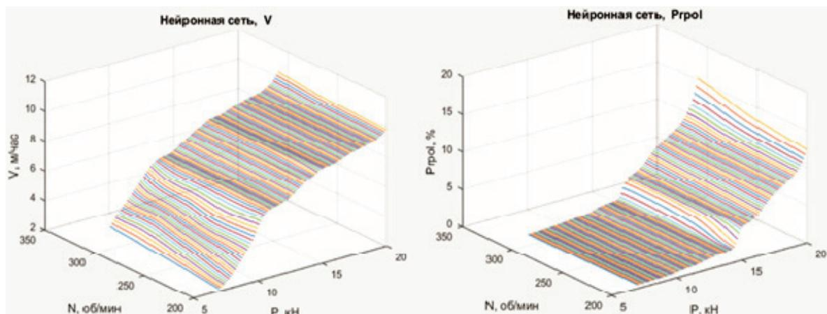
Рис. 3. Реакция сети на входные воздействия: слева – скорость бурения  $V$ ; справа – процент поломок  $Prpol$
