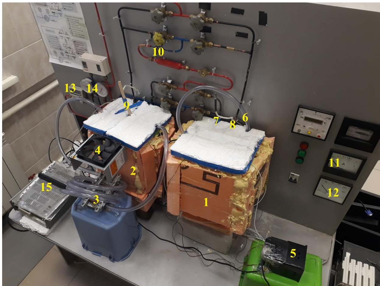
Рисунок 8 – Общий вид теплонасосной установки
