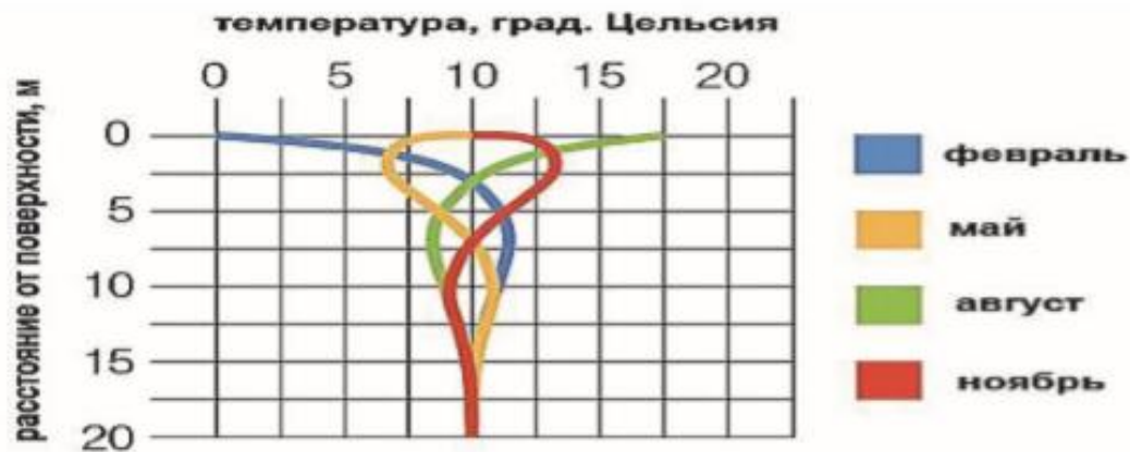
Рисунок 1 – Распределение температур в поверхностном слое земли
