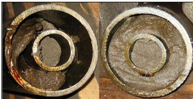
Рисунок – 3 Механические примеси на рабочих органах УЭЦН
