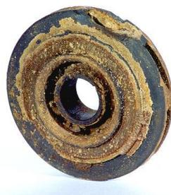
Рисунок – 2 Отложения солей на рабочем колесе УЭЦН
