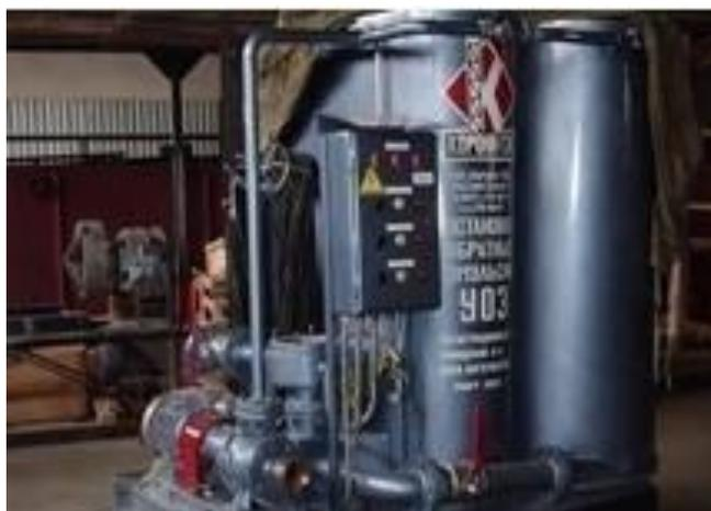
Рисунок – 7 Мобильная установка приготовления эмульсий УОЭ – 1
