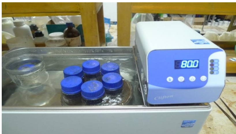
Рисунок 3.5 – Образцы эмульсии в термостате при 80°C.
