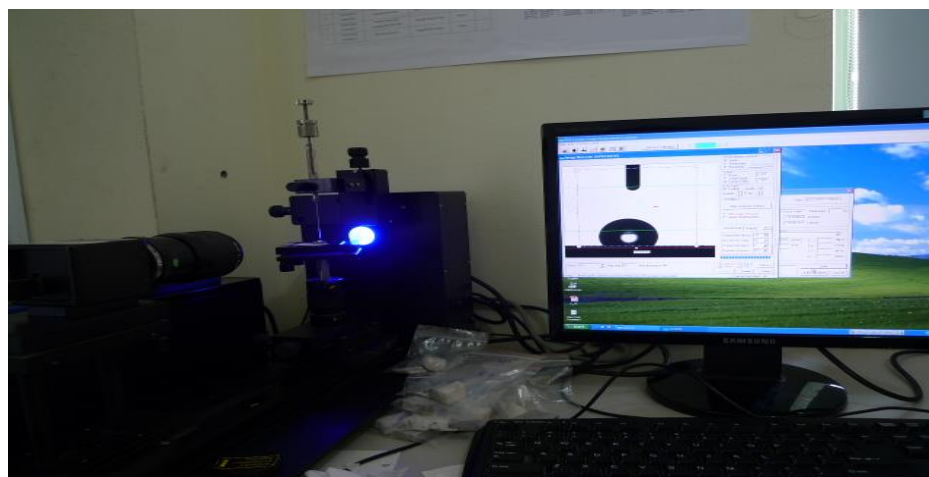
Рисунок 3.9 – Определение угла смачивания на приборе KSV CAM 200 Исследование для подбора гидрофобизатора.
