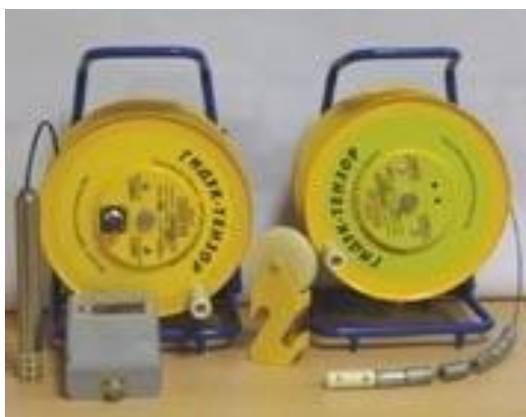
Рис. 3.2 Электроуровнемер УСК-ТЭ 150
