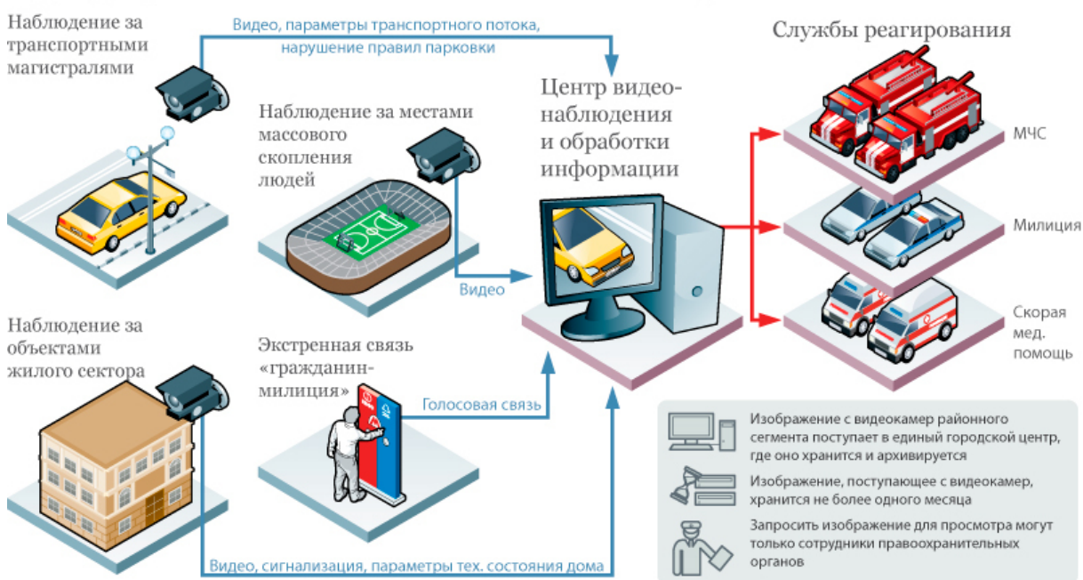
Рисунок 7 - Схема программы АПК «Безопасный город»
