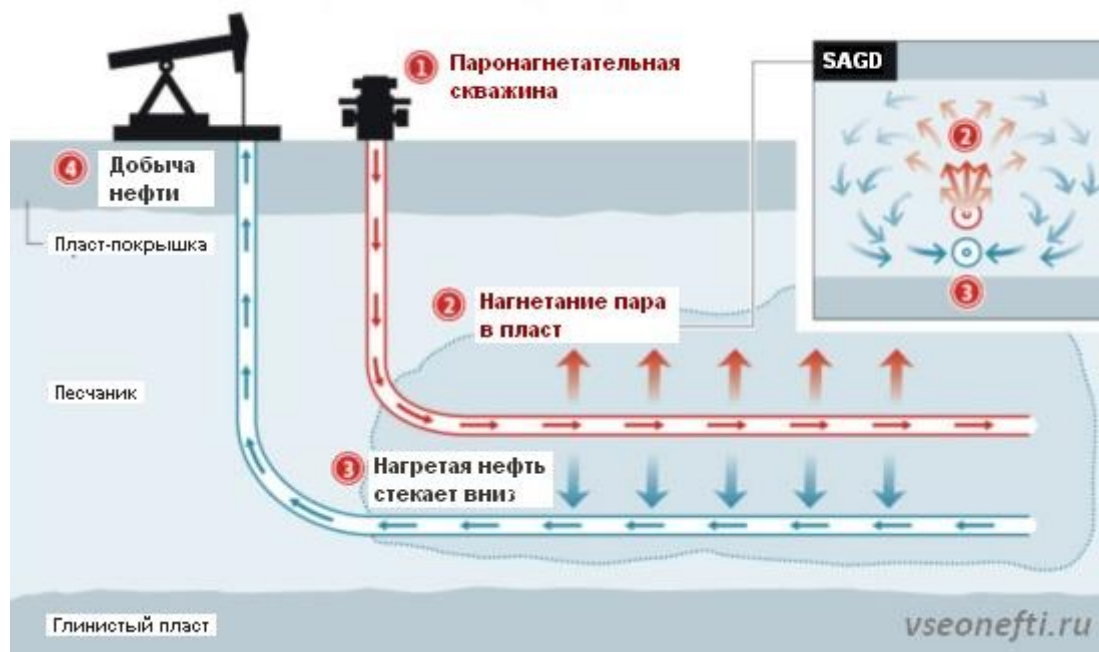
Рисунок 2.5 Схема применения метода SAGD.
