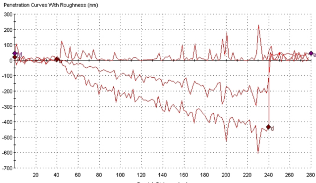
Рисунок 31 - Результаты скрѣч-тестинга керамики состава ZrO_2-5\% Y_2O_3 (по длине)
