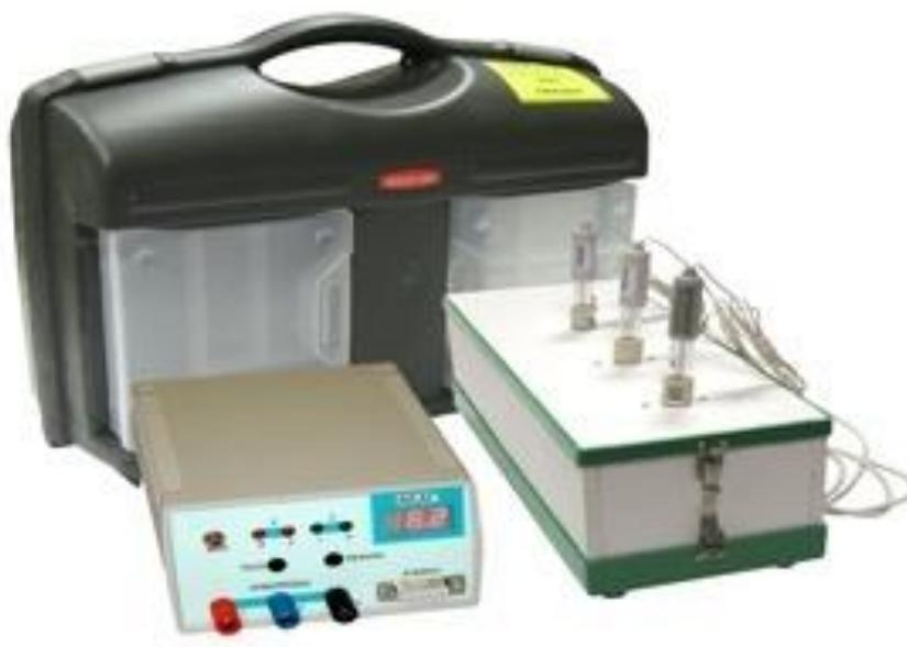
Рисунок 3.3.6.3 Комплексного анализатора коррозионной активности грунта «АКАГ»
