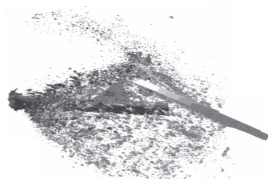
Рис. 3. Удар под углом 60 градусов (ударник: вольфрамовый сплав, радиус 0,2 см, длина 4 см; преграда: сталь, радиус 1,6 см, толщина 0,2 см, v=2764 м/с)
